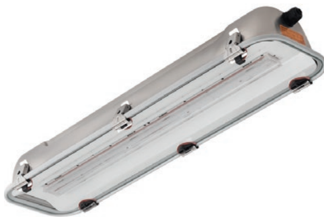
Figura 1. As luminárias RINO LED-EX da Palazzoli possuem certificação ATEX emitida por uma entidade externa para as zonas 2, 21, 22 (e em breve também para a zona 1): II 3G -Ex ec mc IIC T6/T5 Gc (Gases) e II 2D - Ex tb IIIC T85 °C Db (Poeiras). As luminárias RINO_EX LED estão certificadas para suportar temperaturas de -40 °C a +55 °C. A entrada do cabo é efetuada através de um bucin M20.
